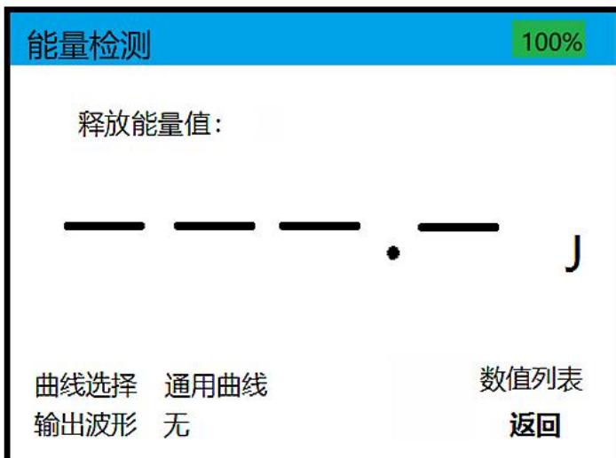
**曲线选择：**通用曲线，迈瑞系列，飞利浦及单向波，为了更准确的检测除颤器的能量释放值，因此本产品对多款除颤器做了更加准确的校准，选择对应的曲线后，在具体的能量释放及检测过程中，误差将可以控制在 5% 内，更多的测量点可以控制在 3% 内。选择通用曲线则误差范围较大，一般满足在 15% 内的国标要求内。因此通过选择品牌更准确的进行检测。
