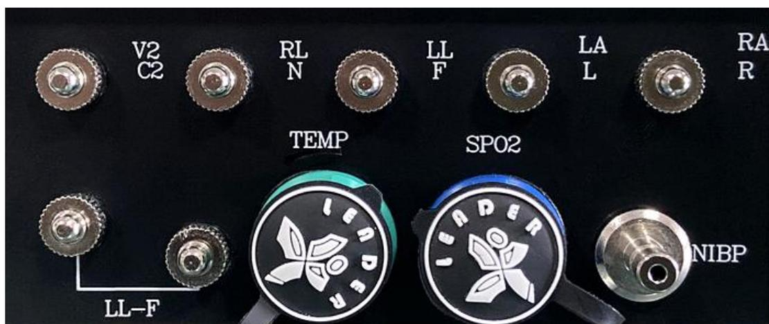
心电图机插针式导联线连接端口
