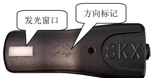
请将模拟手指的这一面 (如上图) 放置到血氧探头的接收管端
