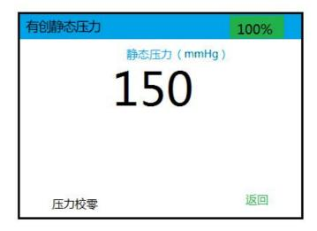
静态压力:设置输出信号的静态压力,对应为有创压的平均压力数值;
