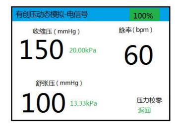
此窗口为设置电信号输出,请连接电信号连接线到有创压仪器。
