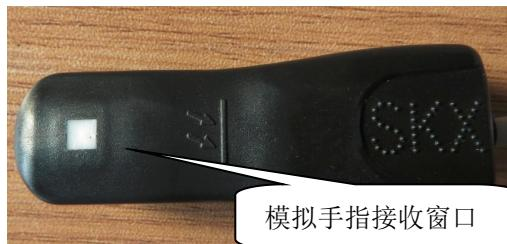
请将模拟手指的这一面（如上图）放置到血氧探头的红色发光管端
