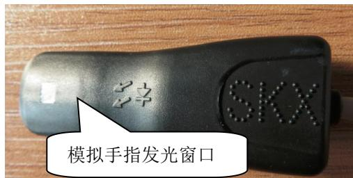
请将模拟手指的这一面（如上图）放置到血氧探头的接收管端
