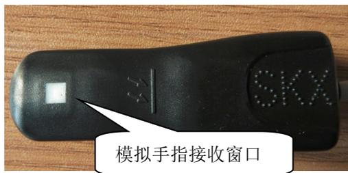
请将模拟手指的这一面（如上图）放置到血氧探头的红色发光管端
